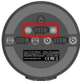
Im NOISE-MOTION Betrieb werden die zwei Mikrophone zur Raumüberwachung aktiviert.
